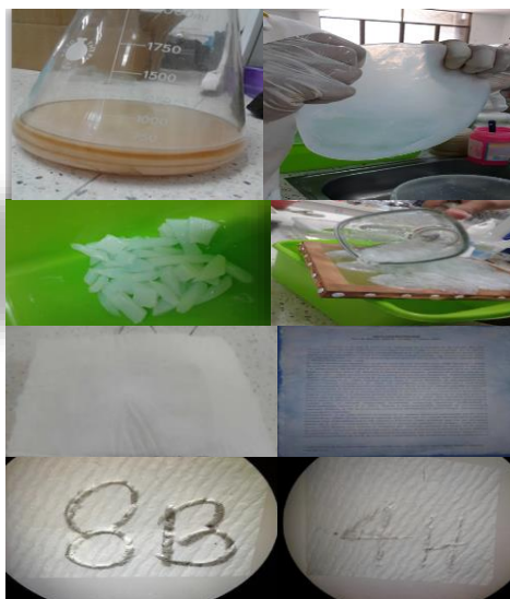
Figura 1: Proceso de producción de papel de CB.
