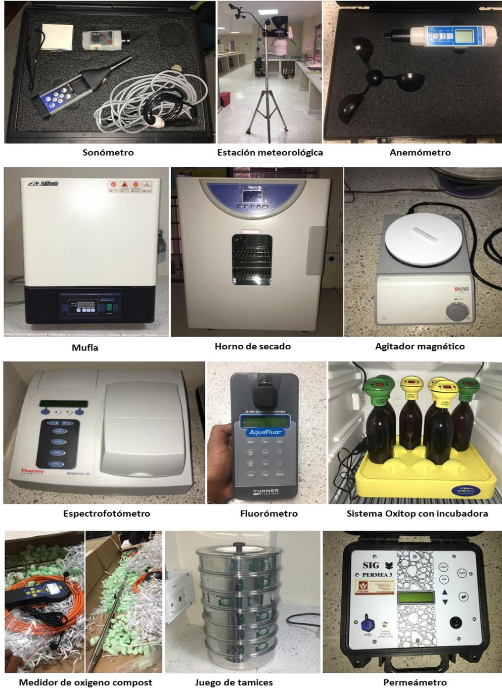
Figura 9. Equipos adquiridos para el Laboratorio Integrado de Ingeniería Ambiental en el 2019
