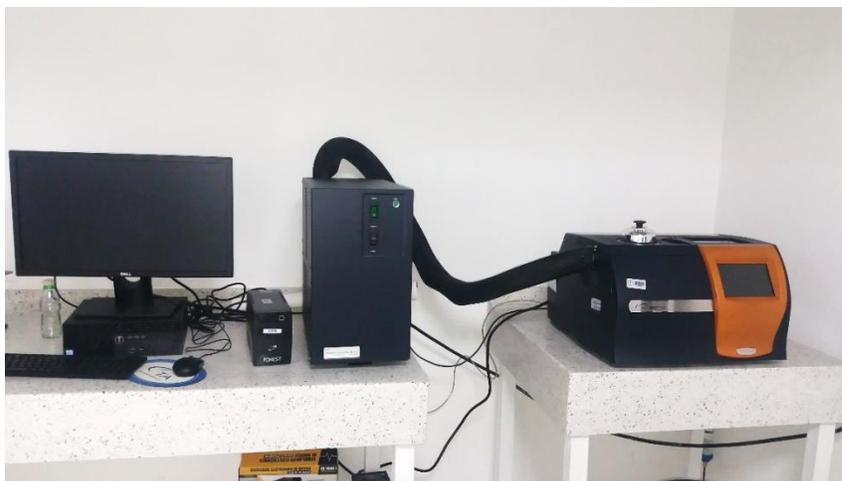
**El calorímetro diferencial de barrido** (DSC 250 TA Instruments) mide las temperaturas y los flujos de calor asociados con las transiciones térmicas de un material. La cantidad de muestra que se utiliza es muy pequeña (5 – 25 mg).
