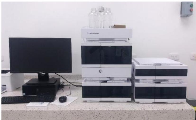
El HPLC 1260 Infinity II LC System Agilent es un equipo que cuenta con una bomba cuaternaria, detector de diodos y detector de índice de refracción empleado para la cuantificación y detección de azúcares, etanol, vitaminas, entre otros.
